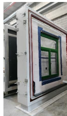
FIGURE 3. ÉTAPES DU PROTOCOLE HAMSTER POUR L'ÉVALUATION DE LA VALEUR U_w DES FENÊTRES
