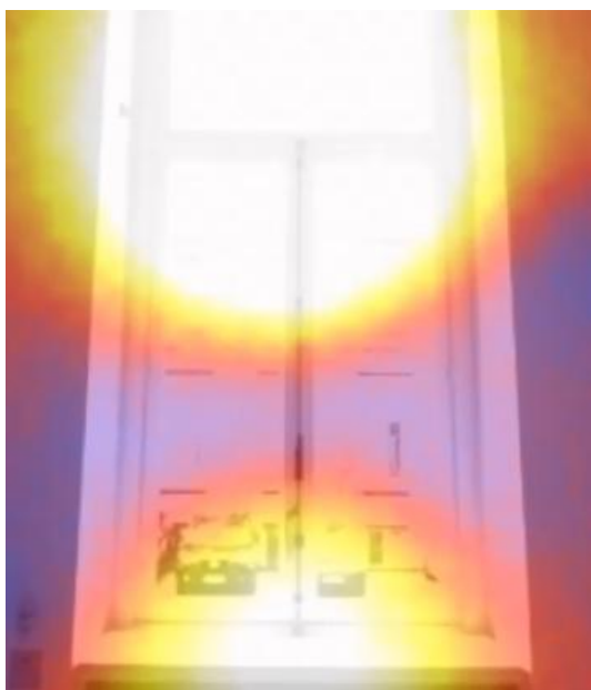
FIGURE 6. IMAGE TYPE DE CAMÉRA ACOUSTIQUE AVEC SOURCE SONORE PLACÉE À L'EXTÉRIEUR DU BÂTIMENT
