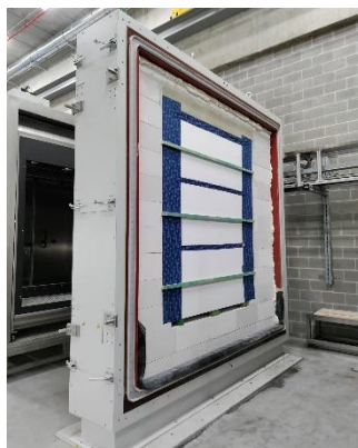
FIGURE 3. ÉTAPES DU PROTOCOLE HAMSTER POUR L'ÉVALUATION DE LA VALEUR U_w DES FENÊTRES
