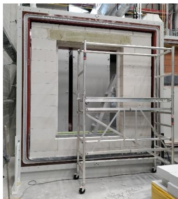
FIGURE 3. ÉTAPES DU PROTOCOLE HAMSTER POUR L'ÉVALUATION DE LA VALEUR U_w DES FENÊTRES
