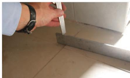
Abb. 1 Messung der reellen Niveauunterschiede zwischen zwei angrenzenden Fliesen.
