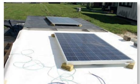
Einfluss einer weißen Membran auf die Temperatur der PV-Paneele.
