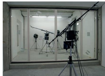
**Abb. 3** Neues Multikanalmesssystem und Testwand.
