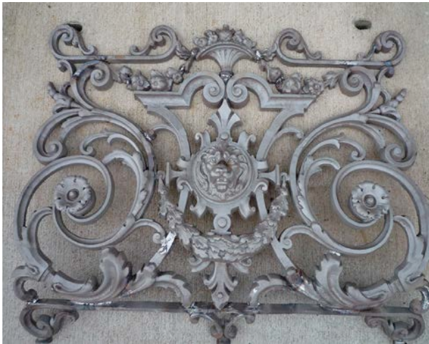
2 | Exemple d'objet complexe en fonte dont le moule en sable pourrait être imprimé en 3D
