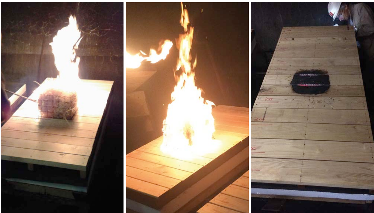
Illustratie van de proef van het begin (ontvlaming van de met houtwol gevulde korf) tot het einde (beperkte beschadiging van de houten bekleding).
