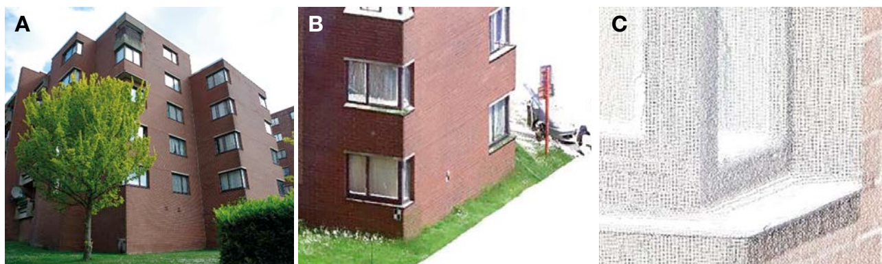
1 | A. Gebouw dat men in 3D wenst te digitaliseren. B. Door een laserscanner gegenereerd 3D-model van het gebouw. C. Zoom op de duizenden punten die het model vormen.
