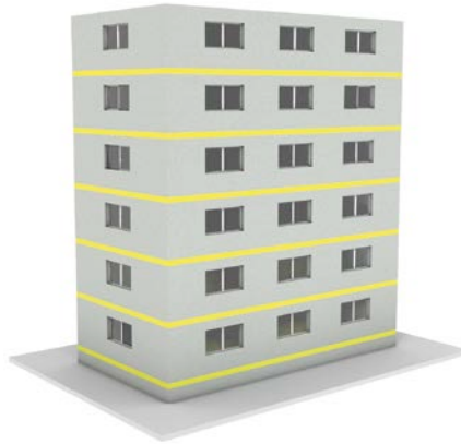
2 | Stroken uit rotswol van 200 mm hoog aan de gevelvoet en per bouwlaag.
