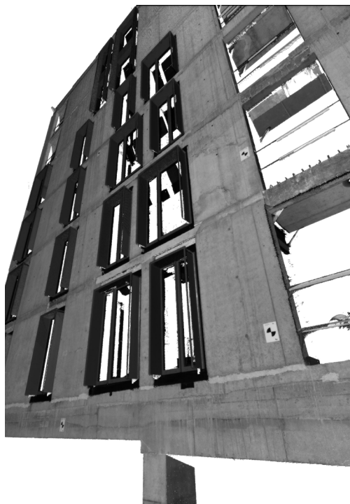
▲ Puntenwolk verkregen via laserscanning (referentiemodel).
