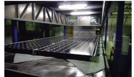
Abb. 1 Prüfgehäuse mit dem man die Windwiderstandsfähigkeit von Flachdächern ermitteln kann.
