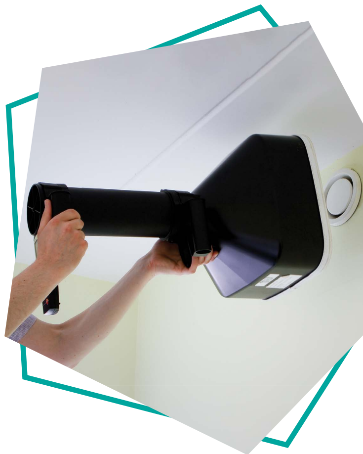
Fig : Mesure des débits de ventilation mécanique au niveau d'une bouche
