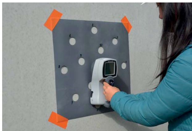
2 | Beoordeling van de tintverschillen met behulp van een kleurmeter en het referentiepatroon uit de norm
