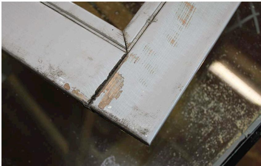
2 | Beschädigung der Ecken als Folge einer nicht optimalen Verleimung
