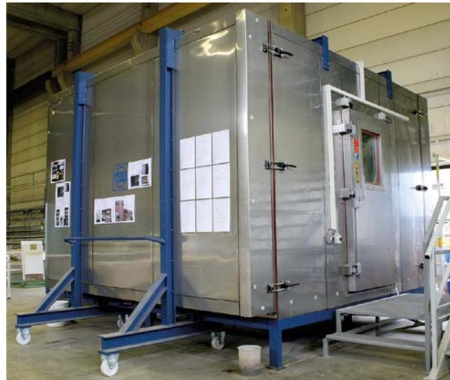
2 | Prüfstand zur Bewertung der Dauerhaftigkeit
