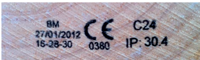
1 | Beispiel einer CE-Kennzeichnung, die auf dem Element selbst angebracht wurde.
