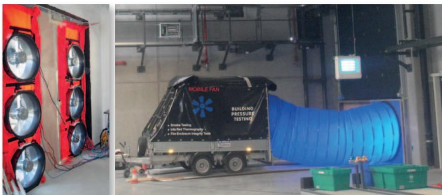
**Abb. 1 und 2** Links: Differenzdrucktüren mit mehreren Ventilatoren für die Durchführung der Prüfungen in großen Gebäuden. Rechts: an sehr große Gebäude angepasster Ventilator, mit dem Luftmengen in einer Größenordnung von 100.000 m³/h bereitgestellt werden können.
