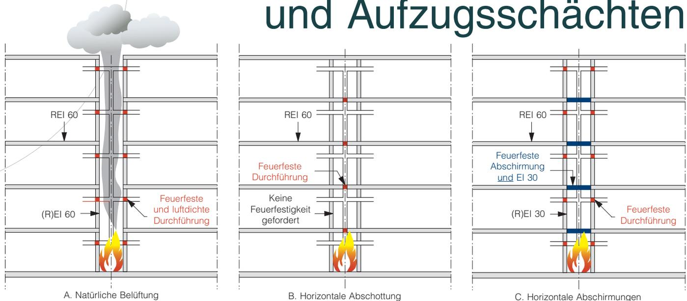
Drei Lösungen, um Luftdichtheit, Lüftung und Brandschutz von Technischächten in Einklang zu bringen (mittlere Gebäude).
