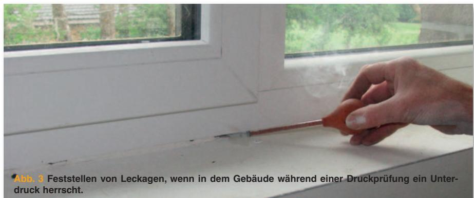
Abb. 3 Feststellen von Leckagen, wenn in dem Gebäude während einer Druckprüfung ein Unterdach herrscht.
