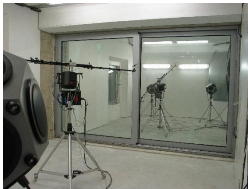
Figure 1 Détermination de l'indice d'affaiblissement acoustique R en laboratoire selon NBN EN ISO 10140-2.
