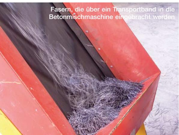
Fasern, die über ein Transportband in die Betonmischmaschine eingebracht werden
