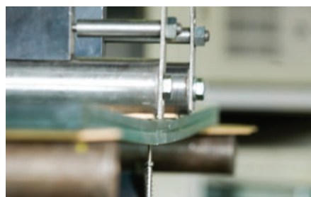
Biegeversuch an Verbundglas.
