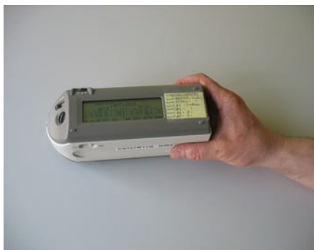
Abb. 2 Messung des Reflexionskoeffizienten mithilfe eines Spektralkolorimeters.
