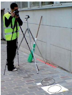
FIGUUR 75: OPMETEN VAN CONTRAST MET FOTOTOESTEL
