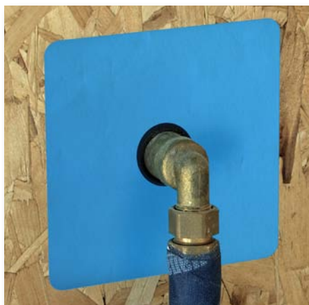
Afb. 4 Verlijming van een mof op een OSB-plaat voor binnengebruik.
