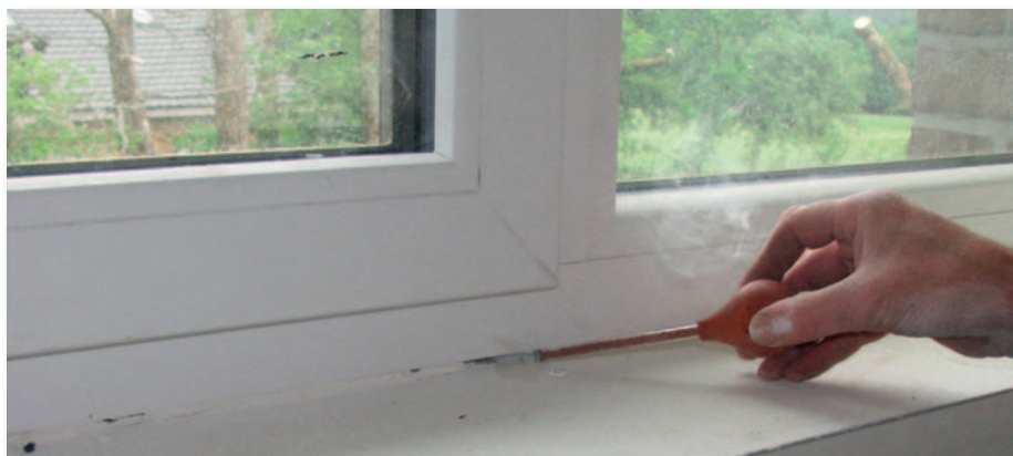
Afb. 3 Opsporing van luchtlekken wanneer het gebouw in onderdruk geplaatst wordt tijdens een pressurisatieproef.
