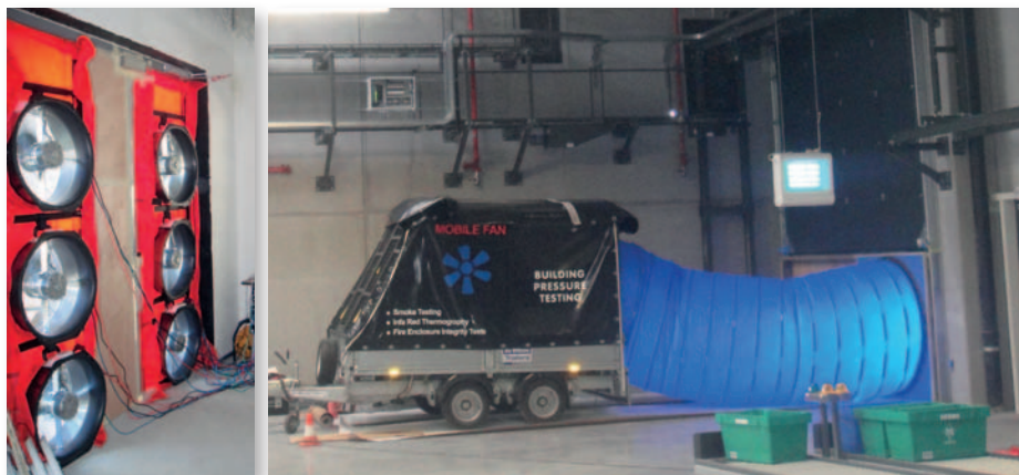
Afb. 1 en 2 Links : deuren met meerdere ventilatoren voor de uitvoering van proeven in grote gebouwen. Rechts : ventilator die aangepast is aan zeer grote gebouwen en waarmee het mogelijk is om luchtdebieten van om en bij de 100.000 m³/h te bereiken.
