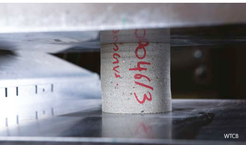
1 | Druksterkteproef op een boorkern met een lengte-diameterverhouding van 1:1.
