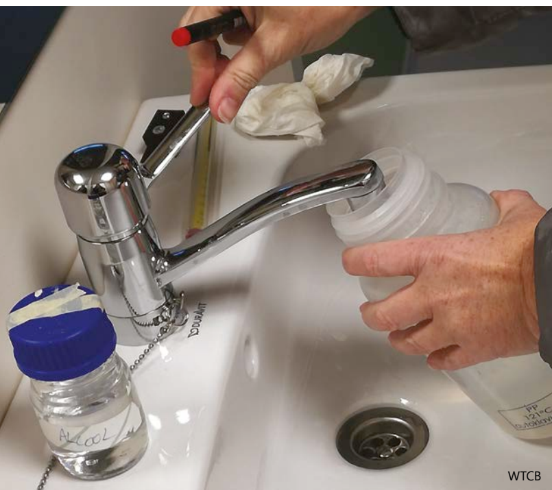
1 | Staalname aan een wastafel na de spoeling.
