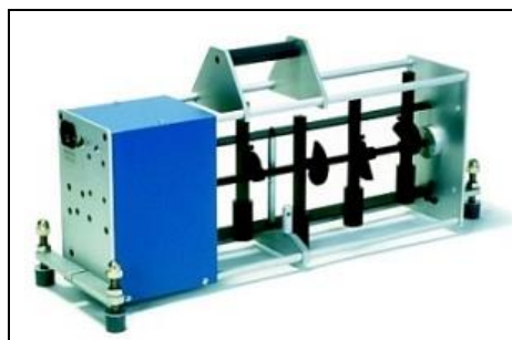
Afb 1. Bepaling van het genormaliseerde contactgeluidsdrukniveau L_n in het laboratorium volgens NBN EN ISO 10140-3.
