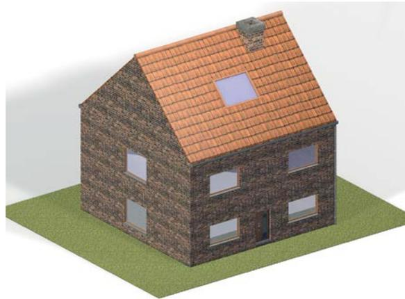
1 | Der Sachverhalt, ob die Behandlung des Baudetails ggf. rentabel ist, wurde anhand eines freistehenden Hauses mit einer Mauerwerksoberfläche von 300 m<sup>2</sup> und einem Fassadenfuß von 40 m Länge untersucht.
