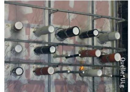
9 | Brandversuch an einer Anzahl von Leitungsdurchführungen.
