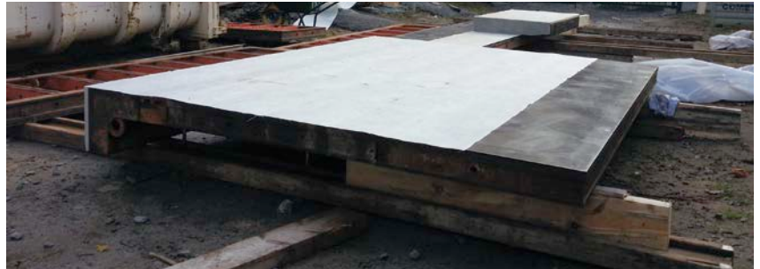
1 | Bekistingsplaat die gedeeltelijk voorzien werd van een CPF-liner
