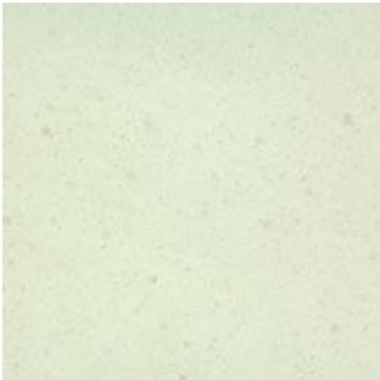
Calcaire de teinte blanc beige à matrice transparente dans laquelle les oolithes oolithes sont facilement reconnaissables. Ici et là, on constate la présence de petits fragments de coquillage. Les pores se localisent surtout entre les oolithes. De fins stylolithes (à faible amplitude primaire) sont présents sporadiquement.
