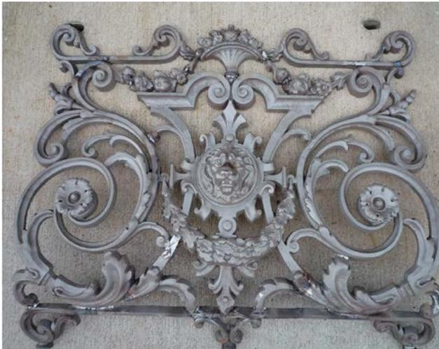
2 | Exemple d'objet complexe en fonte dont le moule en sable pourrait être imprimé en 3D
