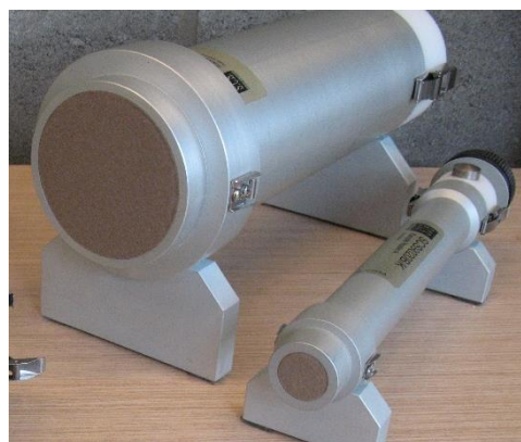
Afb. 1 Bepaling van de absorptiecoëfficiënt \alpha voor loodrechte geluidsval in de buis van Kundt volgens NBN EN ISO 10534.
