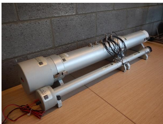
Afb. 1 Bepaling van de absorptiecoëfficiënt \alpha voor loodrechte geluidsval in de buis van Kundt volgens NBN EN ISO 10534.
