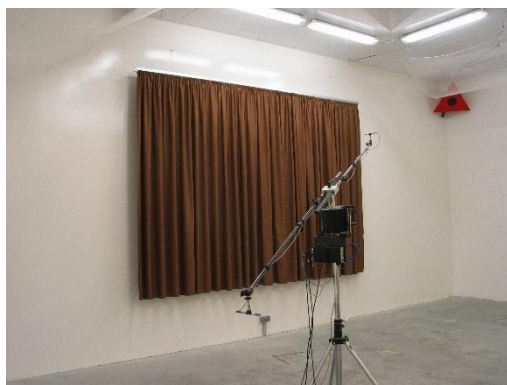
Afb. 2 Bepaling van de absorptiecoëfficiënt \alpha_s voor diffuse geluidsinval in de nagalmkamer volgens NBN EN ISO 354.
