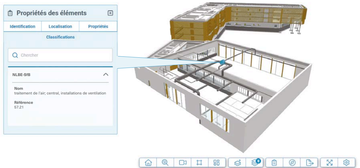
1 Centrale de traitement de l'air avec sa classification NLBE-SfB dans un modèle BIM.
