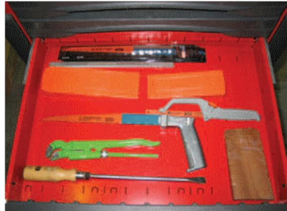
**Figure 3** Les sets d'outils A1 et A2 pour l'essai manuel sur des éléments de la classe de résistance à l'effraction RC2.
