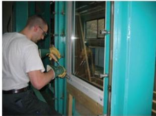
**Figure 4** Essai manuel à l'effraction
