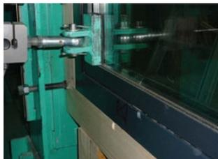
Lors de l'essai statique (voir Figure 1), un vérin hydraulique est utilisé pour exercer une charge en différents points de l'élément (points de fermeture et de suspension, angles du panneau de remplissage, etc.). Les charges appliquées, la durée de l'essai et les déformations maximales autorisées dépendent du type d'élément et de la classe de résistance visée.
