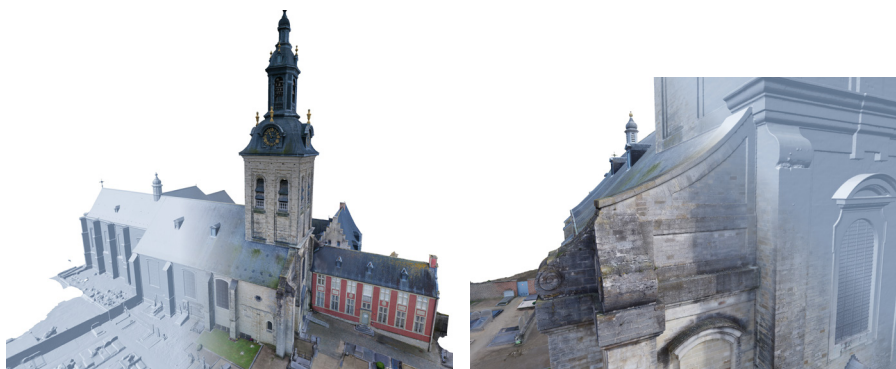
À gauche : maillage 3D de l'Abbaye du Parc à Leuven, créé avec des photos prises par un minidrone et un logiciel de photogrammétrie. À droite : détail des ornements.
