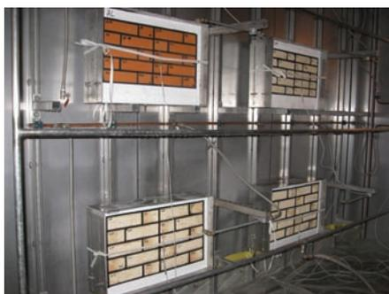
**Fig. 1** Essai de gel sur des murets, selon la CEN/TS 772-22.
