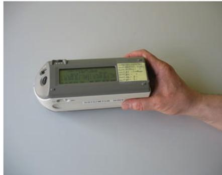
**Fig. 2** Mesure du coefficient de réflexion à l'aide d'un spectrocolorimètre.
