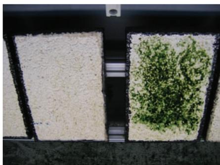
**Essai de sensibilité au verdissement des systèmes d'enduits.**
