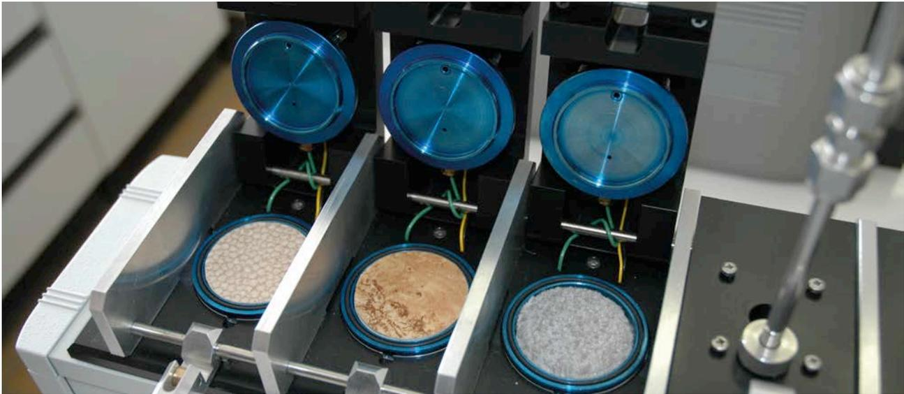
Emissionsmessung an verschiedenen Bodenbelagstypen im Rahmen des TAP-Projekts HEMICPD
