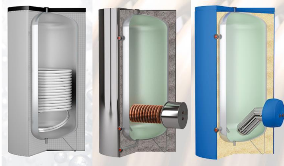
Echangeurs de chaleur internes d'une même marque présentant, de gauche à droite, respectivement : une spirale à axe vertical, une spirale à axe horizontal et un échangeur tubulaire (source Cordivari).
