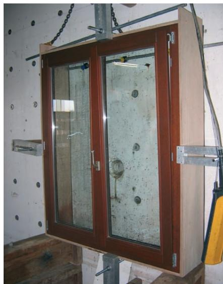
Test d'étanchéité à l'air et à l'eau d'une fenêtre.
