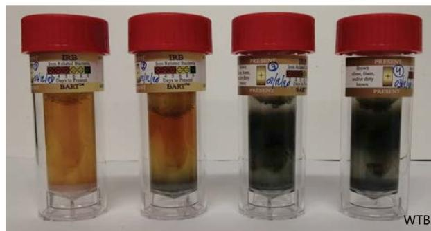
2 und 3 | Ergebnis der Messung der Konzentrationen von sulfatreduzierenden Bakterien (links) und eisenreduzierenden Bakterien (rechts)
