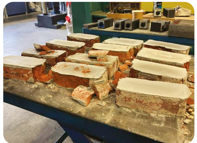
1 Briques en terre cuite de réemploi testées en compression par Buildwise.
