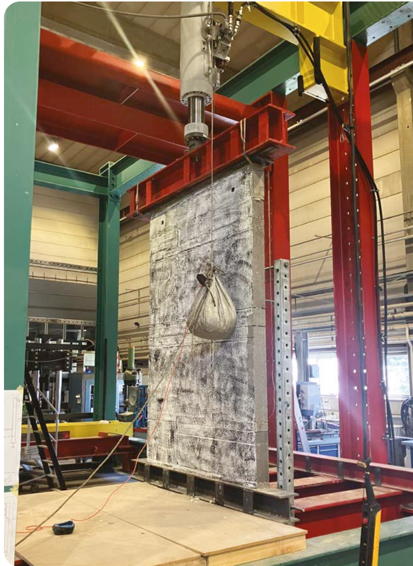
2 Essais de caractérisation d'un système de maçonnerie circulaire dans le cadre du projet CIBER.
