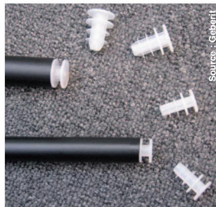
Bouchons placés à l'extrémité des conduites par le fabricant
