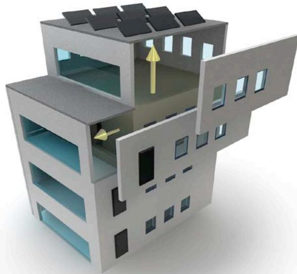
1 | Principe de rénovation constitué d'éléments de façade préfabriqués appliqués sur les murs existants
