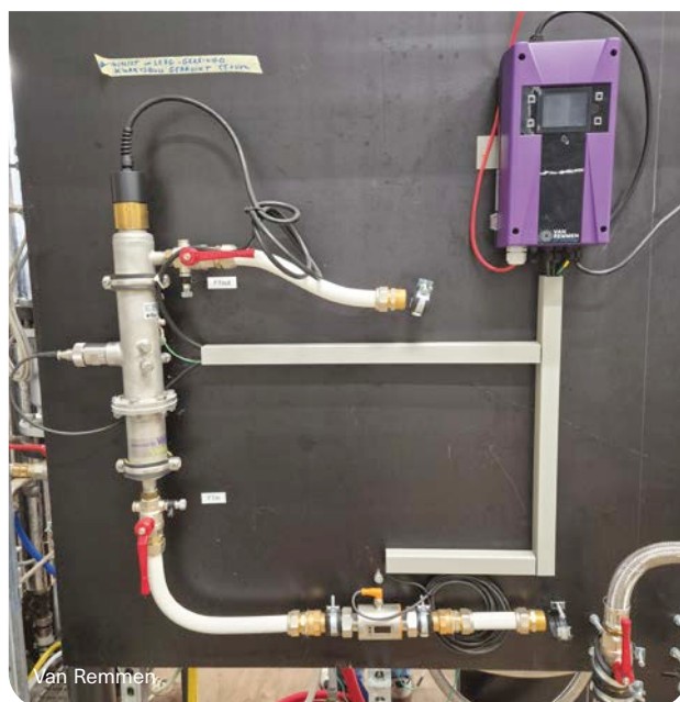
2 Proefopstelling met ultrafiltratiesysteem (boven) en ultravioletsysteem (onder).
