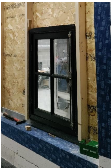
FIGURE 22. SIMPLE OUVRANT AVEC CROISILLONS (BOIS), TESTÉ EN LABORATOIRE
