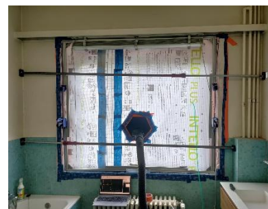
FIGURE 16. MISE EN PLACE DU DISPOSITIF DE MESURE POUR LA FENÊTRE RUE DES DARPIERS, 44
