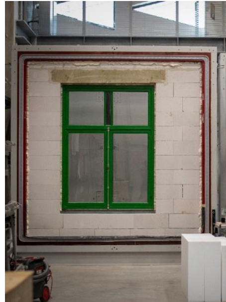
FIGURE 10. DOUBLE OUVRANT AVEC IMPOSTE FIXE (BOIS) OUVERTURE GUEULE DE LOUP, TESTÉ EN LABORATOIRE
