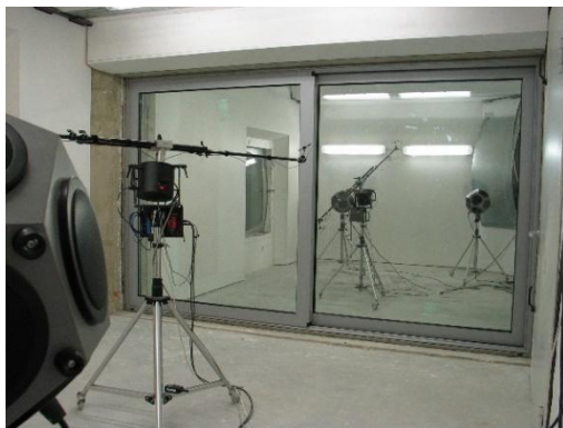
Afb. 1 Bepaling van de geluidsverzwakkingsindex R in het laboratorium volgens NBN EN ISO 10140-2
