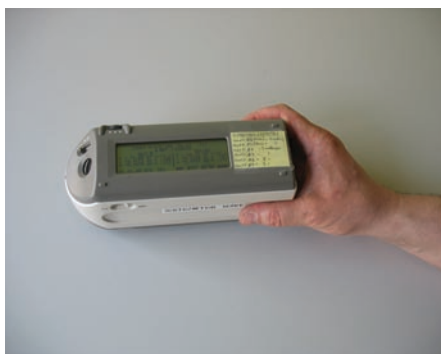
Afb. 2 Meting van de reflectiecoëfficiënt met behulp van een spectrorcolorimeter.
