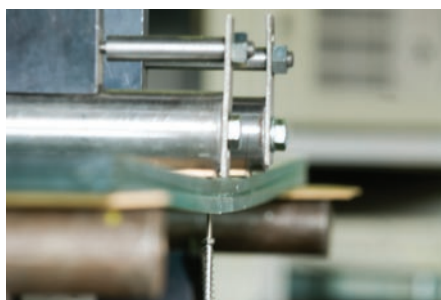
Buigproef op gelaagd glas.
