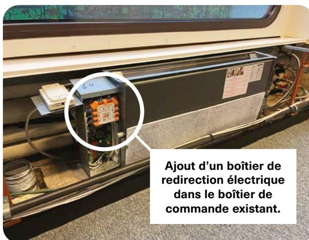
Ajout d'un boîtier de redirection électrique dans le boîtier de commande existant.
