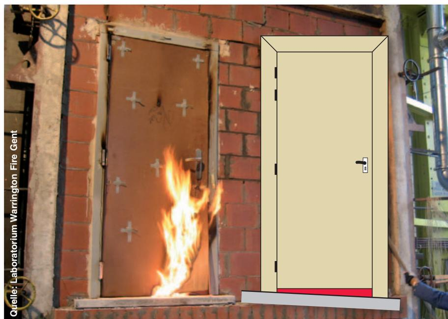
Abb. 1 Mängel in der Ebenheit und/oder Horizontalität des Bodens im Bereich der Brandschutztür in geschlossener Position und Durchschlag von Flammen.
