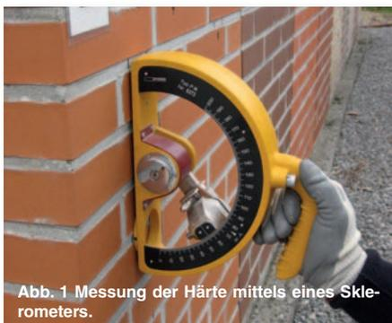
Abb. 1 Messung der Härte mittels eines Sklerometers.
