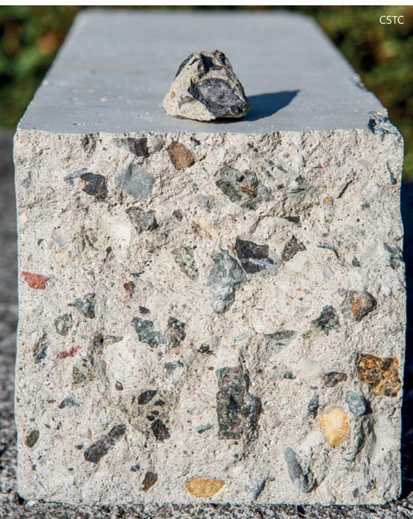
1 | Granulats de béton recyclés.
