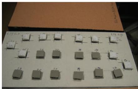
**Essai d'adhérence d'un système d'enduit appliqué sur un matériau isolant.**
