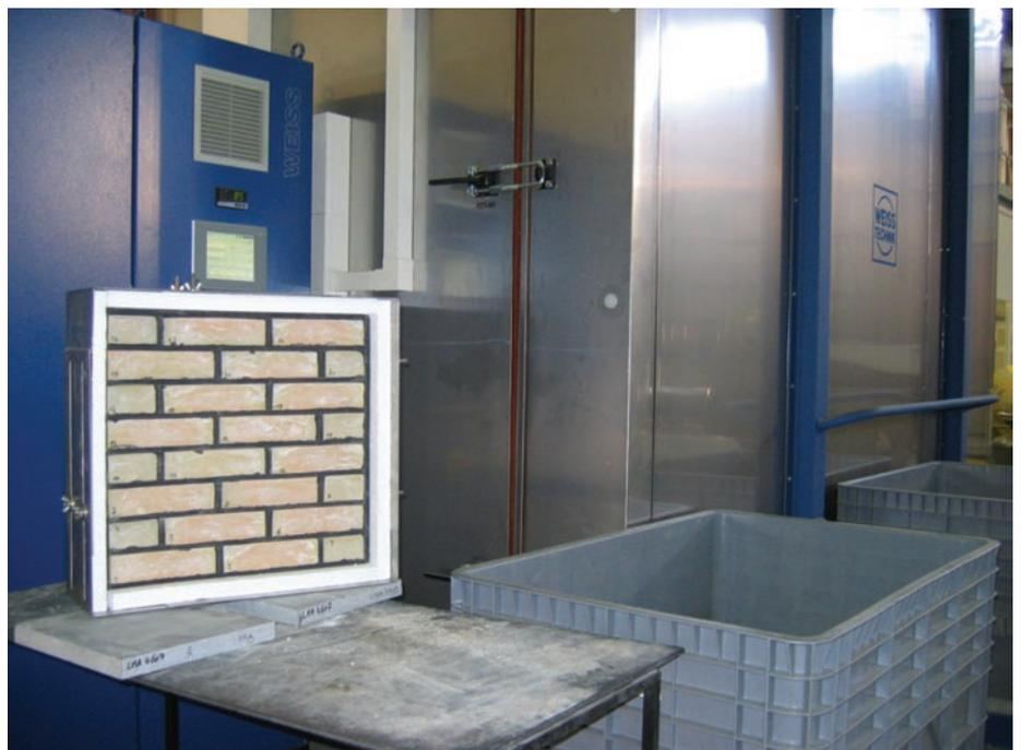
Poste d'essai visant à tester la résistance au gel d'une maçonnerie de façade.
