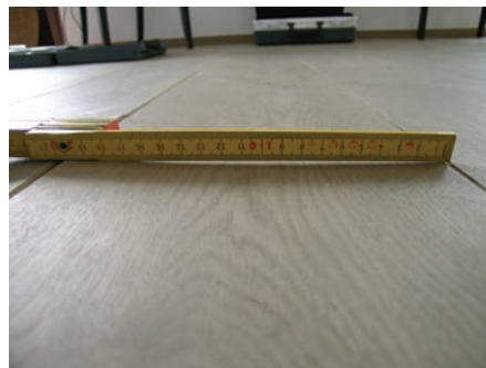
Afb. 1 Het kromtrekken (of schotelen) van de parketstroken is een vaak voorkomende pathologie.
