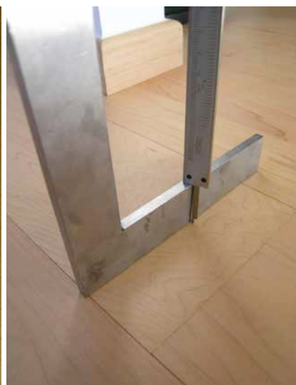
Controle van de breedte van de voegen bij de oplevering (links) en van de schoteling van de parketstroken (rechts).
