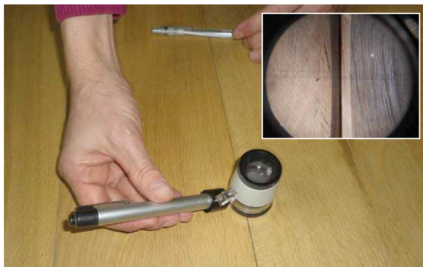
Controle van de breedte van de voegen bij de oplevering (links) en van de schoteling van de parketstroken (rechts).
