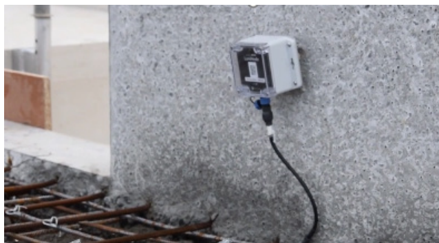
Fig. 4: Capteur pour optimiser le moment du décoffrage d'une dalle en béton
