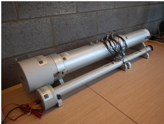
Figure 1 Détermination du coefficient d'absorption acoustique \alpha sous incidence normale du bruit à l'aide du tube de Kundt selon la norme NBN EN ISO 10534.
