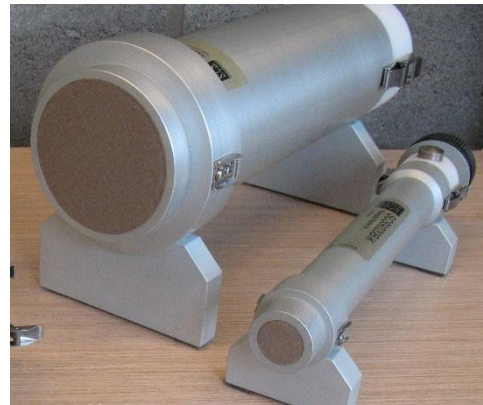
Figure 1 Détermination du coefficient d'absorption acoustique \alpha sous incidence normale du bruit à l'aide du tube de Kundt selon la norme NBN EN ISO 10534.
