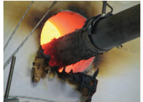
Fig. 1 Le resserrage d'un tuyau à l'aide de mousse sans performance au feu est inutile, dans la mesure où la résistance au feu n'est pas garantie.
