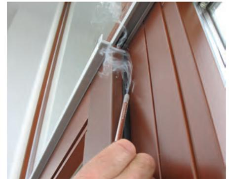
Fig. 2 Détection d'une fuite au moyen d'un fumigène.
