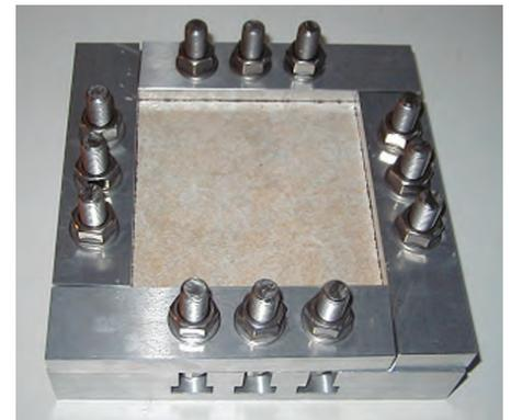
Fig. 2 Cadre métallique dimensionné pour reproduire le blocage.
