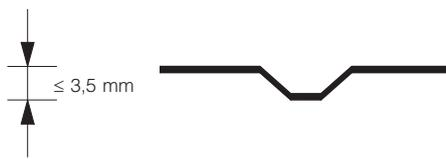
**Abb. 5 Flaches Verteilerplättchen mit kleiner Delle.**
