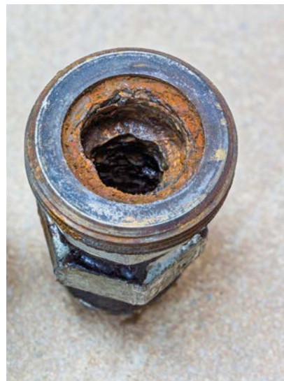
4 Afzettingen van ijzeroxides in de leidingen
