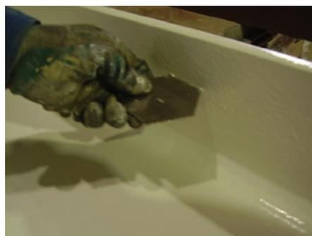
Abb. 2 Messung der Dicke einer feuchten Schicht.
